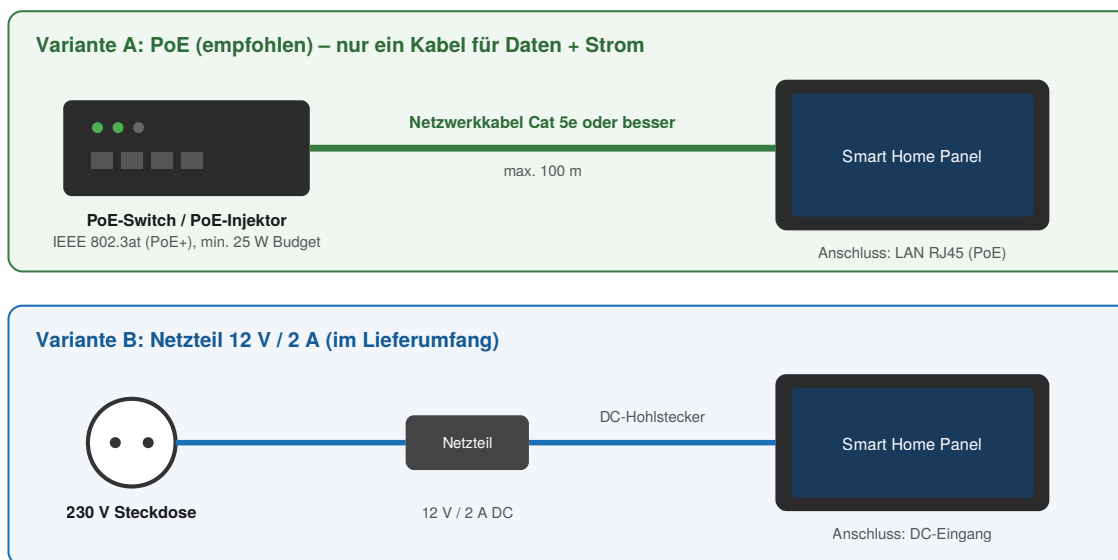
Abb. 5: Versorgungsvarianten – PoE (oben) oder Netzteil (unten)
